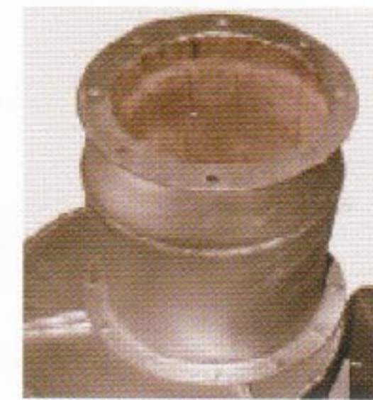
耐熱型煙突 キャストブル内張り (厚み50mm) 高さ600mm
